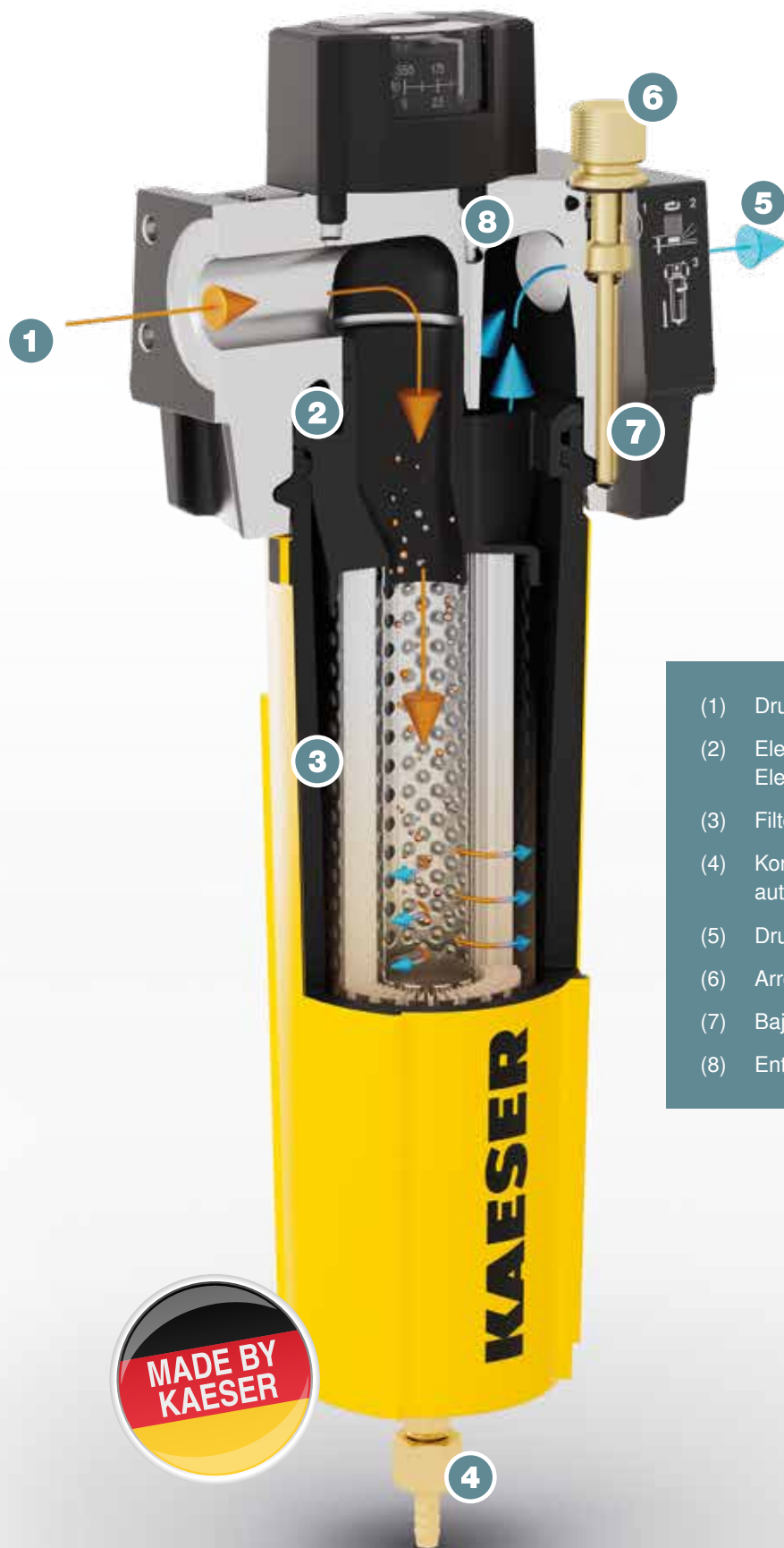
Abb.: Funktionsschema Koaleszenzfilter
